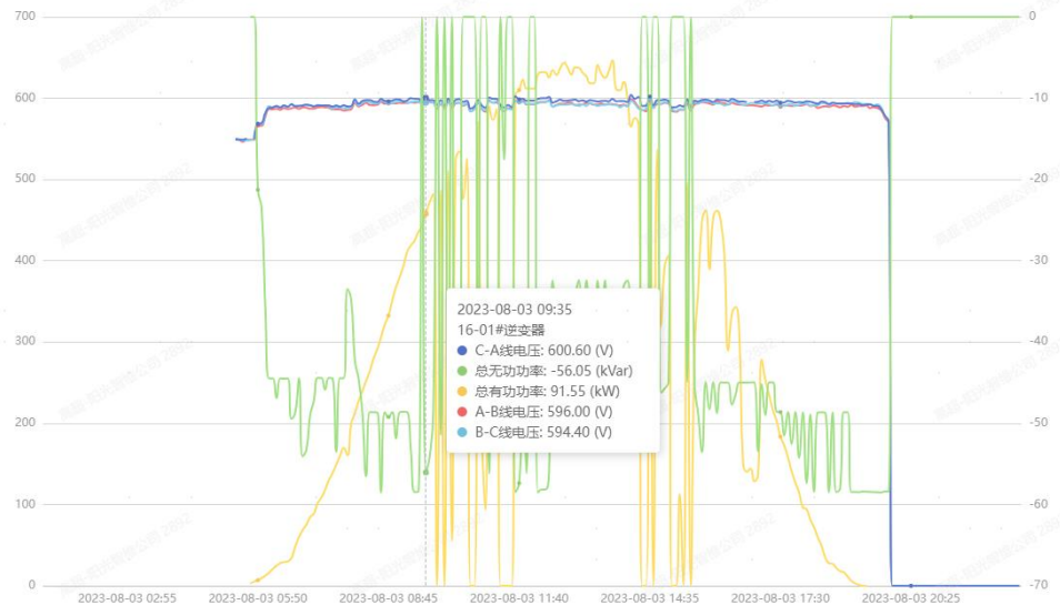
图 2-32 逆变器无功功率过大导致过压停机实例
