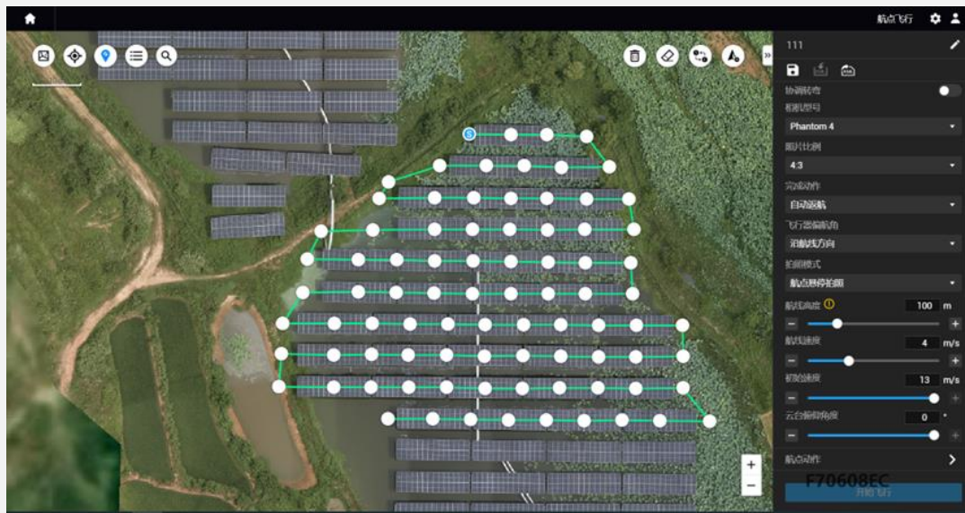
设定航线进行电站正射图像收集
