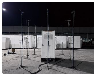
图26 PowerStack 系列储能系统SGS噪音测试，噪音 < 65dB(A)
