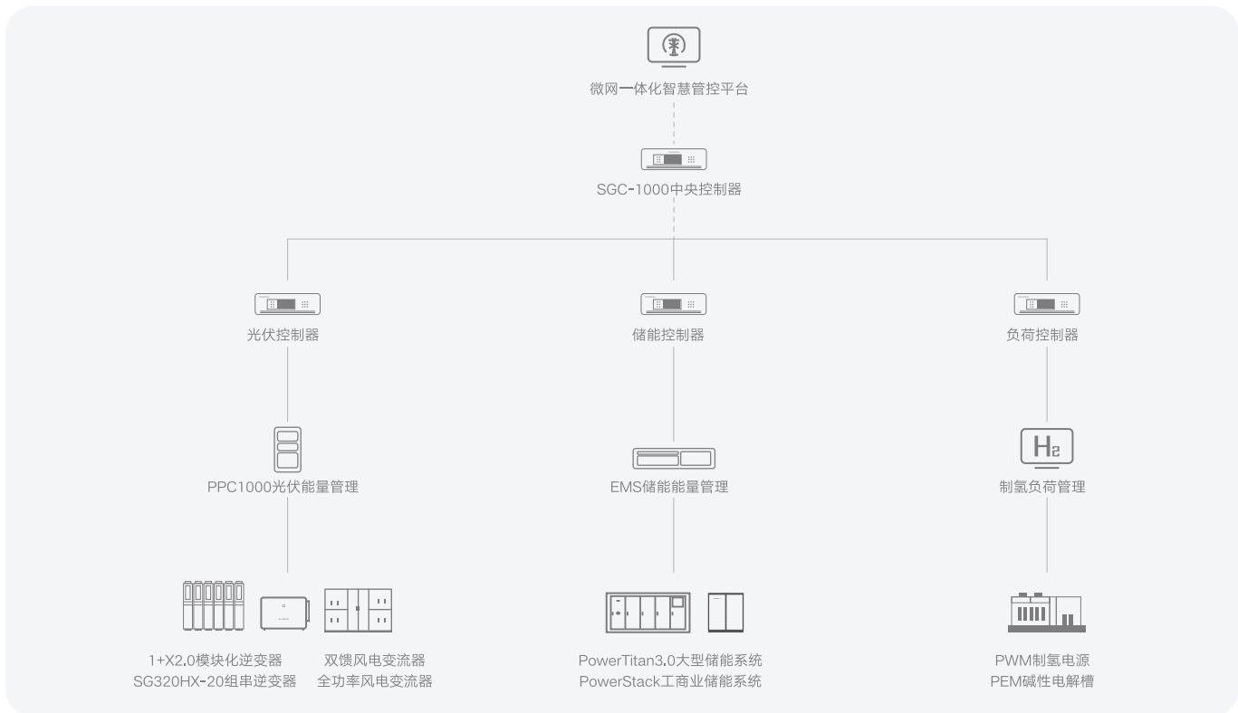
图15 风光储制氢/氨/醇交流耦合系统拓扑示意图
