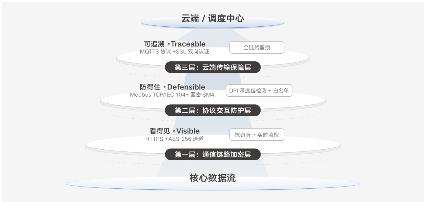
图 43：VDT 三级隔离防护
