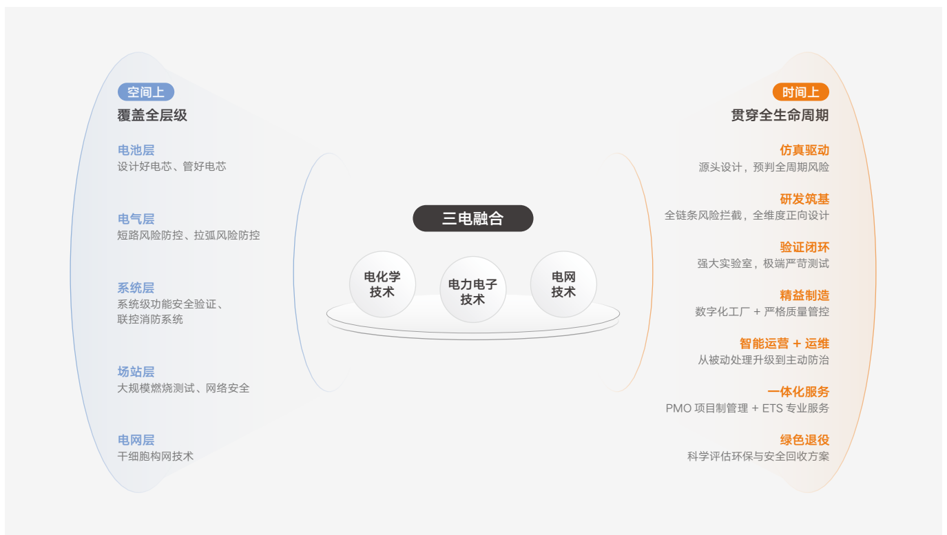
图 10：储能系统全维安全架构图
