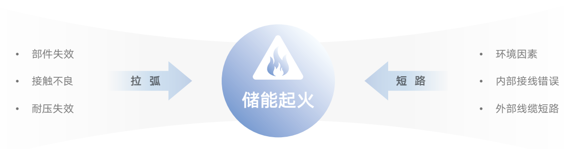
图 6：储能起火电气原因分析
