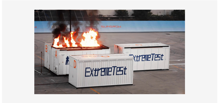
图 40：PowerTitan 大规模燃烧测试现场
