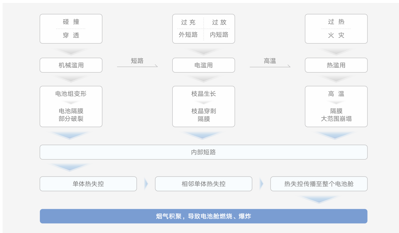
图 5：电池热失控诱因示意图
