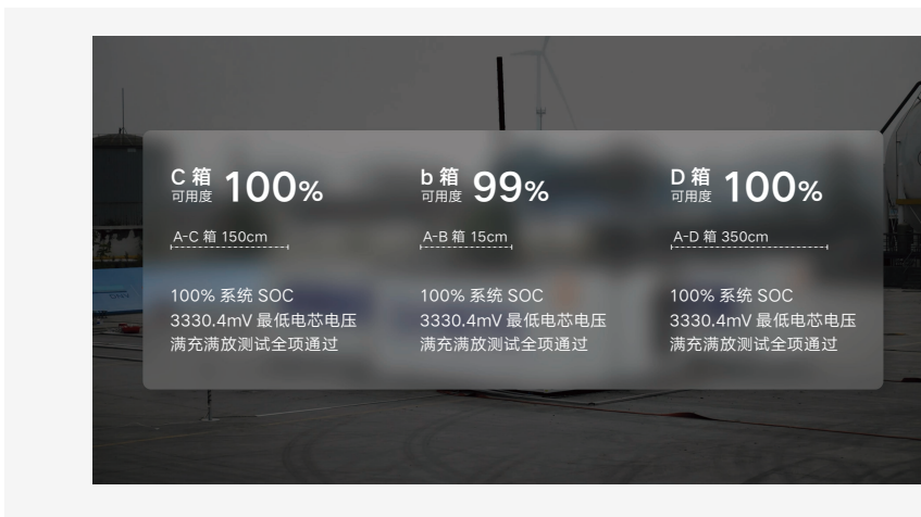
图 41：实验结束后 B 箱可用度为 99%，C 箱可用度为 100%，D 箱可用度为 100%
