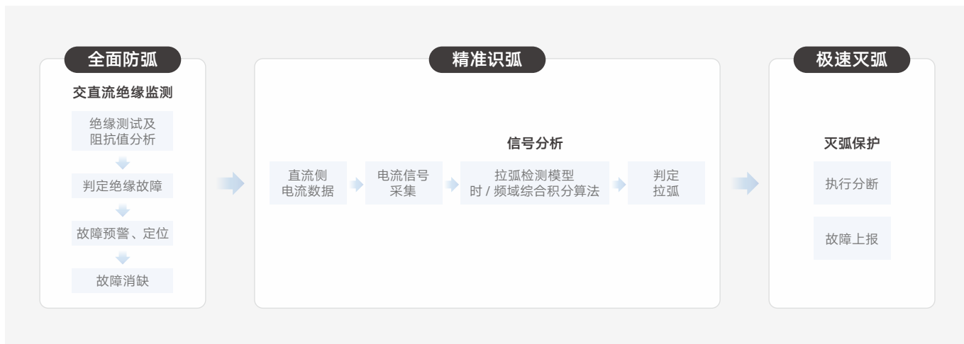
图 27：ArcDefender 储能直流拉弧技术方案
