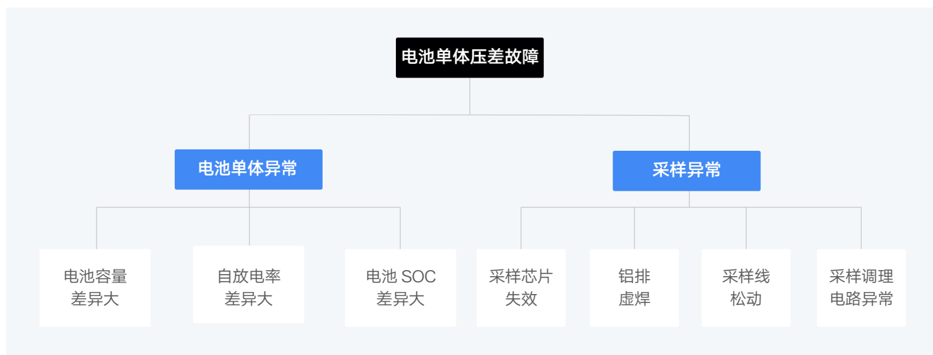
图10：电池单体压差故障对应多种原因示例
