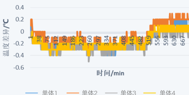
图5：不同温感布局的电池单体温度采集示例及其监测效果对比
