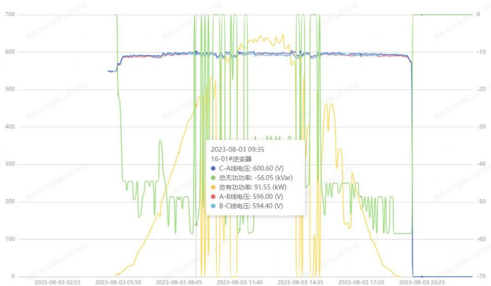
图 2-26 逆变器无功功率过大导致过压停机实例
