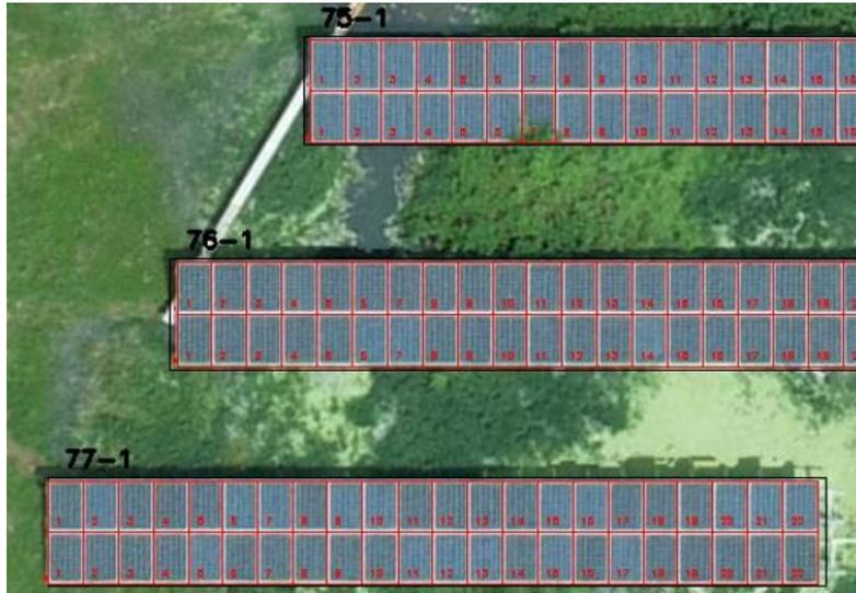
图 2-11 电子地图组串和组件分割图示
